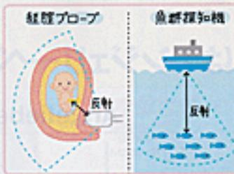
魚群探知機は海面からの物体に超音波が反射する点までの距離を測るもの。超音波写真はこの原理を使っておなかの中にある赤ちゃんの形を認識し、画像として写す。反射の強いものが、弱いものは写りません。
